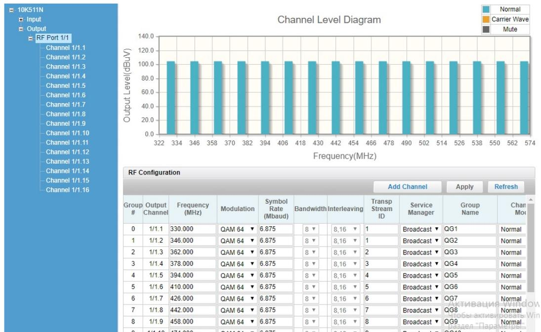
4.8 Для удаления не нужных каналов, в графе « Channel Mod» устанавливаем «delete» и нажимаем кнопку «Apply».
