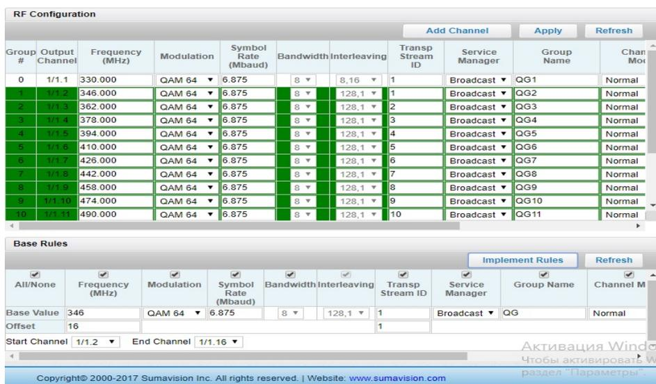
4.7 Нажимаем кнопку «Apply» и контролируем на диаграмме созданные каналы.
