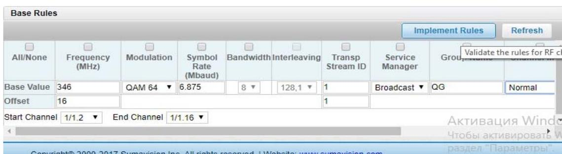
4.6 Выбираем параметры «Start Channel» и «End Channel»; выбираем значение all/none в поле выбора; вводим начальную частоту, смещение, модуляцию, символьную скорость, ID транспортного потока, параметры управления сервисами и т.д. и нажимаем кнопку «Implement Rules».
