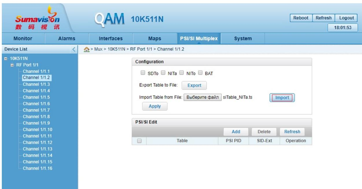
8.2.4 После того как таблица будет импортирована, нажимаем кнопку “Apply”
